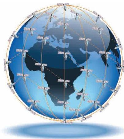
Голосовой вызов или цифровые данные принимаются спутником, ближайшим к текущему местоположению устройства Iridium Pilot, в любом месте на Земном шаре. Трафик направляется по спутниковой сети на наземную станцию сопряжения на Аляске, а затем по наземным сетям к шлюзу в Аризоне. На шлюзе трафик преобразуется обратно в цифровой сигнал протокола IP или голосовой вызов, в зависимости от типа вызова, и доставляется в IP-облако или телефонную сеть общего пользования (PSTN).
