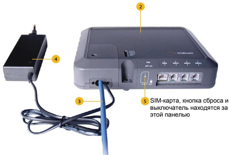
**2. Подпалубное оборудование:** Подпалубное оборудование (BDE) представляет собой блок, к которому подключаются телефоны и компьютеры пользователей. Возможно подключение трех телефонных аппаратов POTS/RJ11 и одной линии Ethernet.
